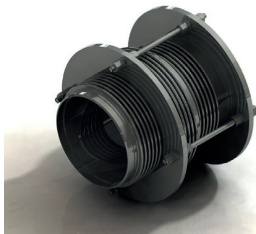
МРВ-І. ЛИНЕЙНЫЙ КОМПЕНСАТОР ДЛЯ ВЫРАВНИВАНИЯ ДАВЛЕНИЯ Абсорбирует осевые и / или боковые перемещения, одновременно сдерживая напор давления. Данный тип компенсаторов используется на прямых участках трубопровода.
